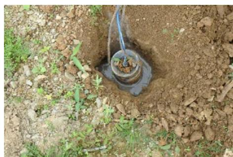
電場量測之非極化電極設置
