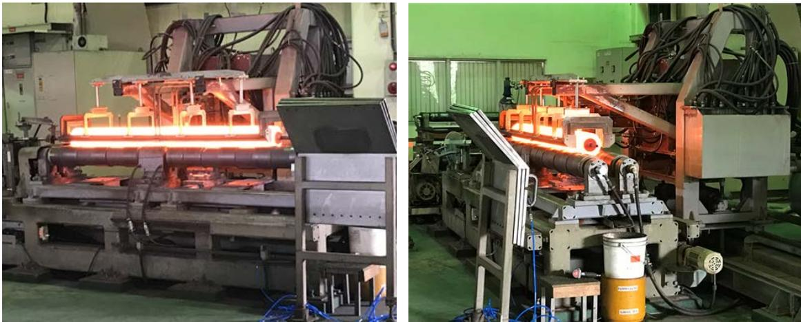
圖 28、管材加熱後離心成形過程
