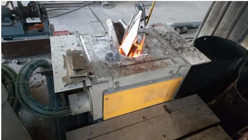
圖 23、高週波爐熔融材料過程
