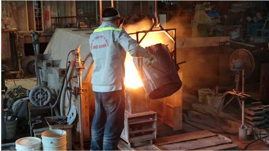
圖 24、將熔融之材料澆鑄至高速旋轉之模具內
