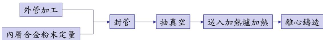
圖 27、粉末離心鑄造流程圖
