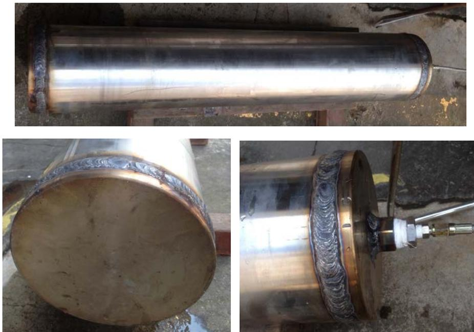
圖 43、試驗完成後之管件本身及兩端並無洩漏及爆破之情形發生
