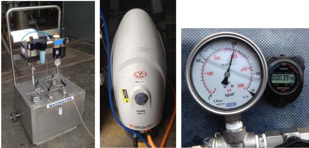
圖 42、依序為高壓液壓氣動系統、高壓加壓機、壓力計和碼表(已達到試驗標準  $196\text{kg}/\text{cm}^2$ 、持壓五秒以上)
