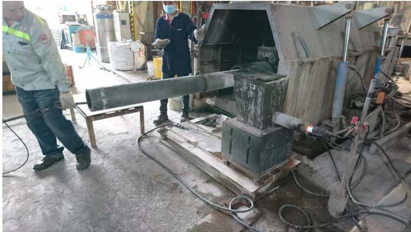
圖 26、將降溫後成形完成之管件由模具中取出
