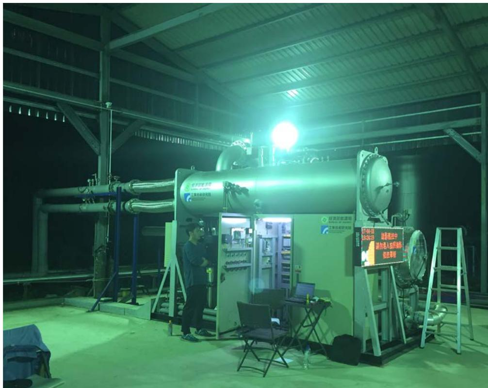
圖 184、200kW 發電機組連續運轉測試
