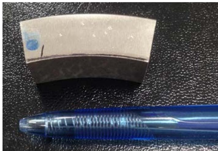
圖 37、經裁切後之硬度測試試片
