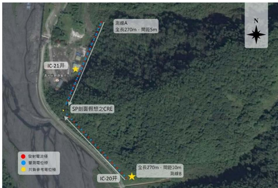
圖 59、清水地熱場址地電阻法與自然電位法監測測線配置圖
