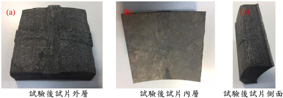
圖 54、(a)~(c)為第二組試片腐蝕後試片表面觀察
