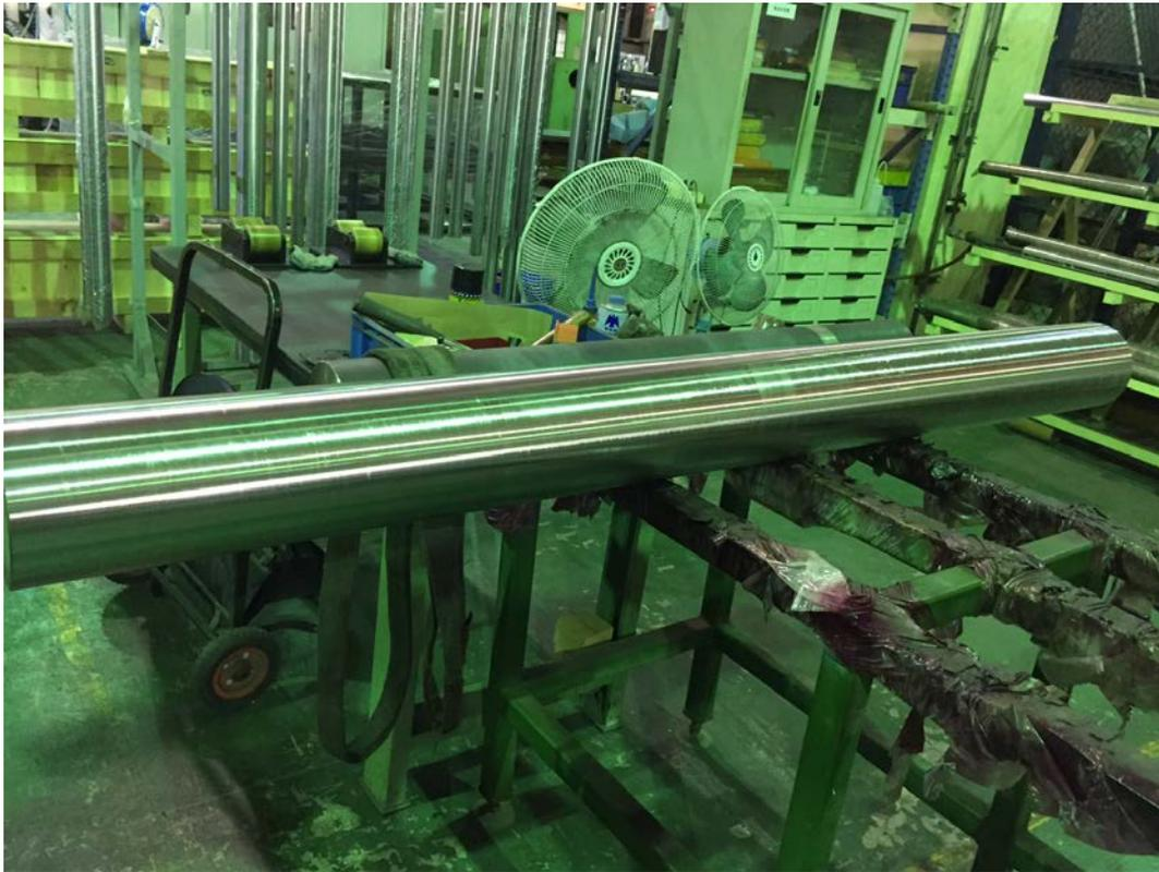
圖 29、精密離心鑄造製作之雙層管件
