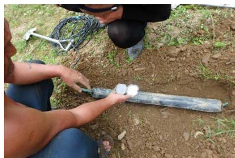
磁場量測之磁力感測棒設置
