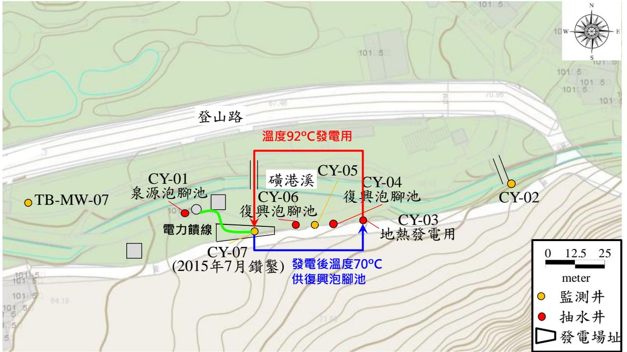
圖 121、耐酸蝕取熱系統於泉源47號公園之熱水迴路與電力饋線示意
