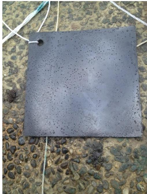
圖 22、SS304 表面電著沉積 epoxy 經實地測試後，表面出現微小凸點
