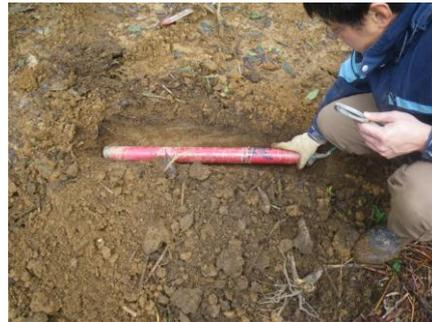
(b)磁場量測之磁力感測器設置
