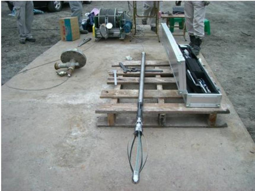
圖 82、PT Geothermal probe 外觀(含Centralizer)
