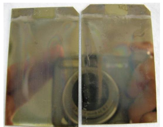
圖 36、SS304 表面電鍍成膜之  $\text{Al}_2\text{O}_3$ ，鍍層乾燥後不沾手並呈現出半透明的狀態
