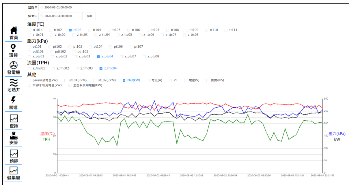
圖 24、電廠遠端監控系統-發電系統歷史資料查詢
