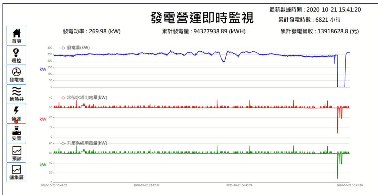
圖 22、電廠遠端監控系統-發電營運即時資訊
